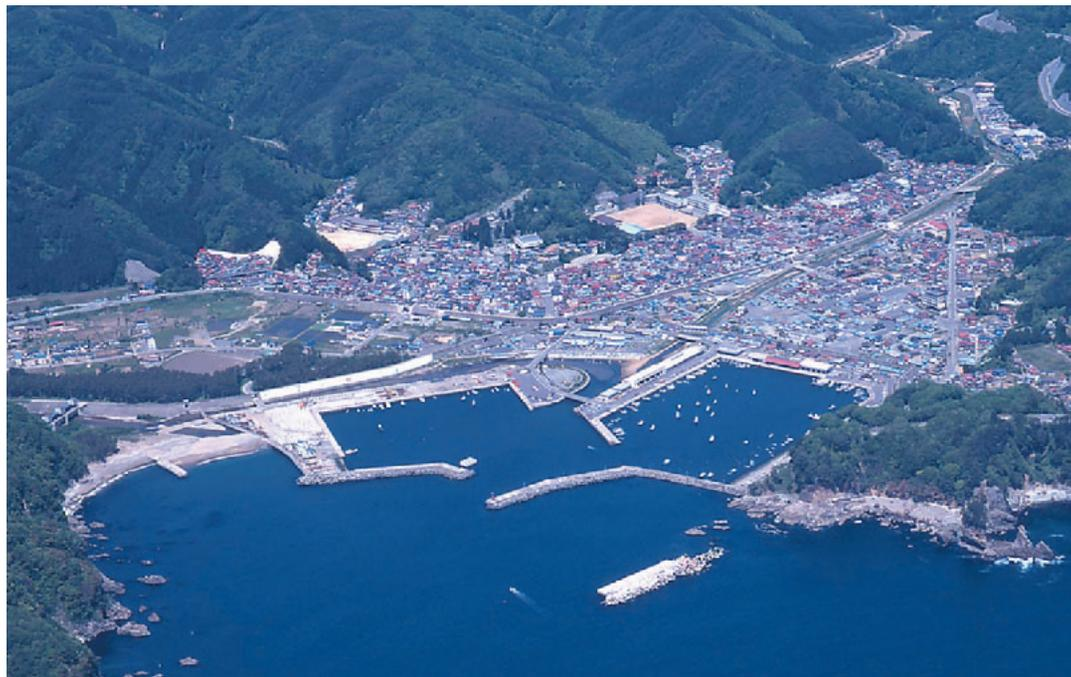
「津波太郎」とまで、ありがたくない異名をもっている宮古市田老町（旧田老町）は、その名のごとくこれまでに数十回の津波被害を受けている。そのなかで慶長16年（1611年）、明治29年、昭和8年の三陸大津波により全町壊滅という大被害を受け、悲惨な経験をした町民と行政が、永久に安住できる田老とするため、津波防災に係わる施設として津波防潮堤を、昭和9年度から整備に着手、昭和53年には総延長2,433m、T.P. + 10.0mの、いわゆる"田老万里の長城"と呼ばれる施設が完成し、以来、背後住民の暮らしを守る上で重要な役割を果たしている。
